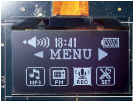
Bild 4: Ablesbarkeit eines OLED im Aufricht (hier von links oben)
